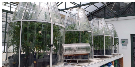
Estufas utilizadas para simular condições de mudanças climáticas no experimento realizado no Laboratório de Fisiologia Ecológica de Plantas da USP | Foto: Janaina Fortirer
